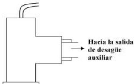
Figura 3. Instalación vertical (tapada) para salidas de desagüe auxiliares.
