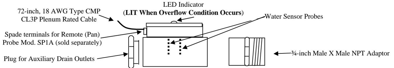
**Figure 1: Safe-T-Probe® Assembly**
